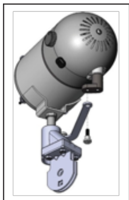
Position A - Pour faire osciller la tête du ventilateur
